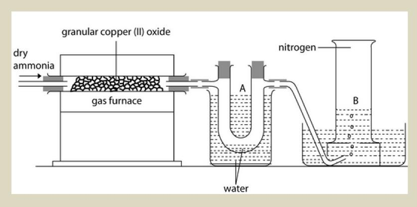
$$3 \text{ CuO}_{(s)} + 2\text{NH}_{3(q)} \longrightarrow 3 \text{ Cu}_{(s)} + 3\text{H}_2\text{O}_{(i)} + \text{N}_{2(q)}$$
