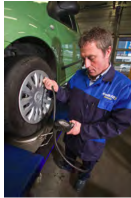
Die meting van die druk binne-in 'n band met behulp van 'n drukmeter.
