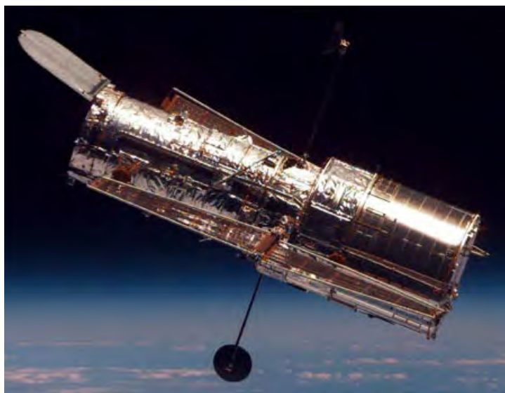
Die Hubble-ruimteteleskoop se versamelspieël het 'n deursnee van 2,4 m.
