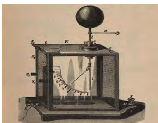
'n Vroeë voorbeeld van 'n elektroskoop met 'n goue strook onder en 'n bal bo-op.
