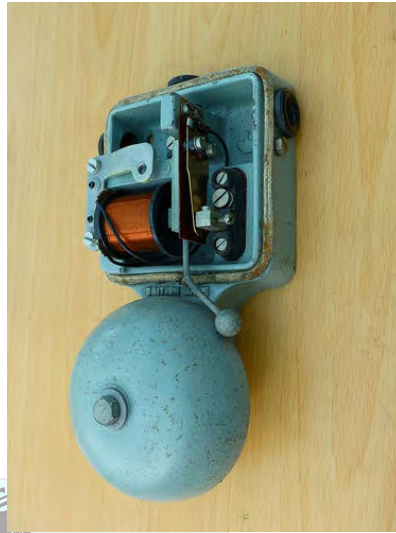
'n Elektromagneet in 'n klokkie.
