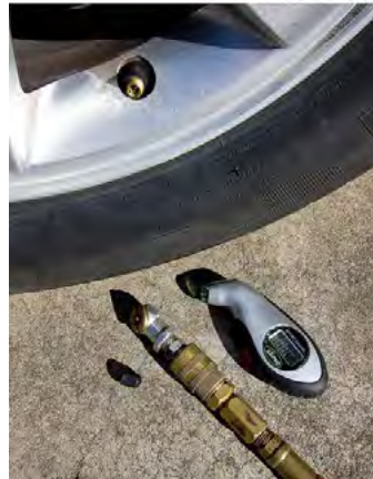
Twee ingewikkelde tipes banddrukmeters vir die meting van banddruk. Die regterkantste een is 'n digitale meter.
